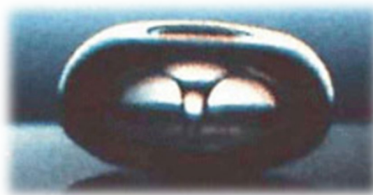
Рисунок 1 – Кавитационный пузырек в момент взрыва [1]
