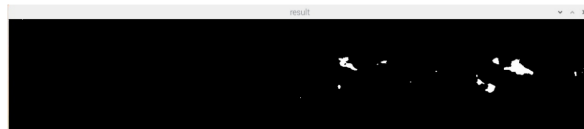
Результат второго этапа обработки изображения - местоположения, размеров области зарегистрированного свечения пород и минералов
