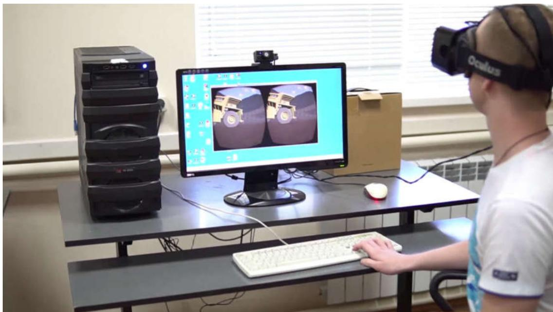
*Рисунок 2. Прототип тренажера-симулятора с использованием технологии VR*
