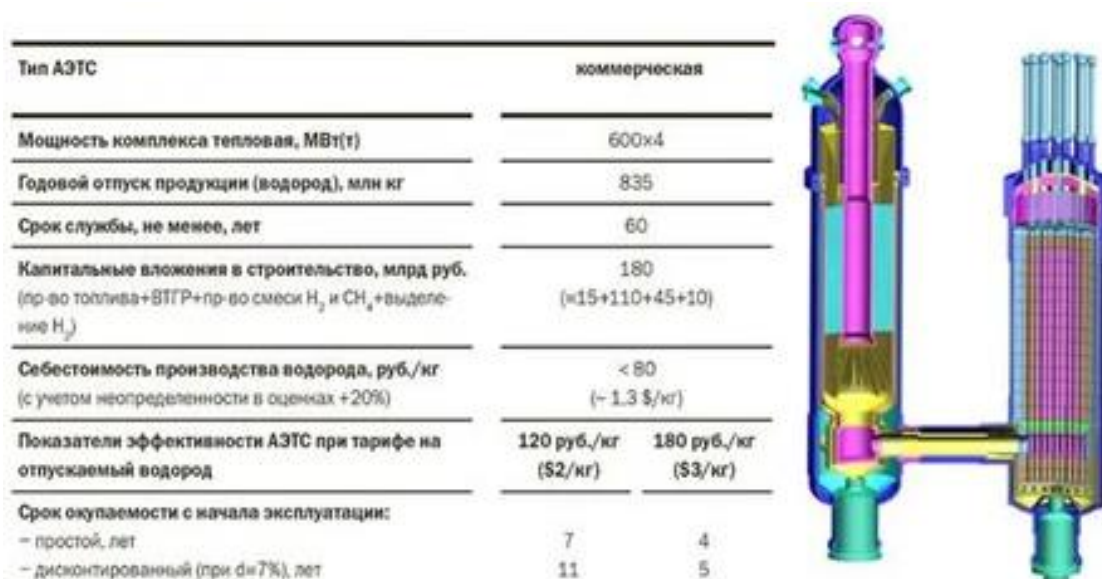
Рисунок 2 - АЭТС на основе ВТГР [4]
