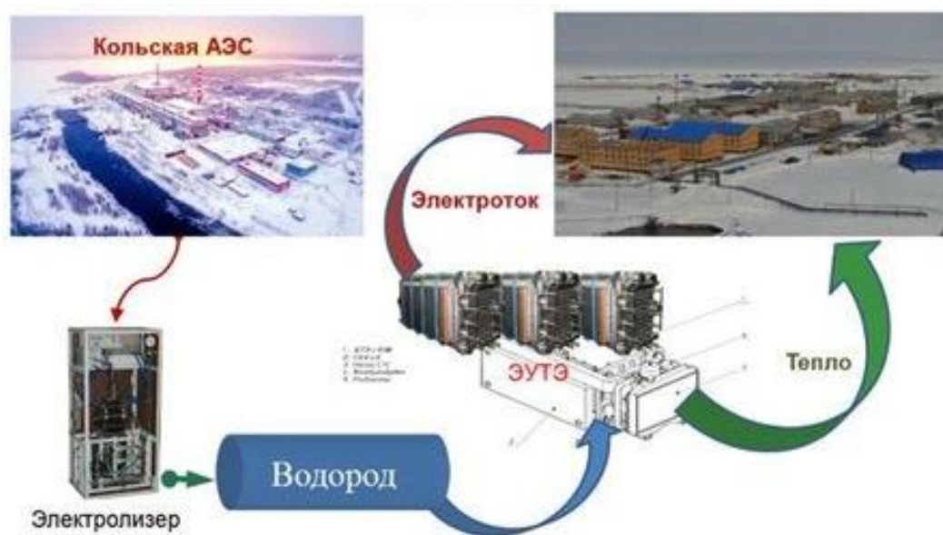
Рисунок 1 – Высокоэффективная система децентрализованного энергоснабжения
