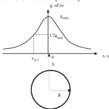
Избыточная плотность – это разность между плотностью искомого объекта и плотностью вмещающих пород. Единица измерения ускорения силы тяжести в системе СГС носит название Гал, более мелкие единицы – мГал и мкГал (1 Гал =  $10^3$  мГал, 1 Гал =  $10^6$  мкГал). 1 Гал – это ускорение, которое развивает масса в 1 г под действием силы в 1 дину. 1 Гал =  $= 1 \text{ дин}/\text{г} = 1 \text{ см}/\text{с}^2$ .
