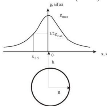
Избыточная плотность – это разность между плотностью искомого объекта и плотностью вмещающих пород. Единица измерения ускорения силы тяжести в системе СГС носит название Гал, более мелкие единицы – мГал и мкГал (1 Гал =  $10^3$  мГал, 1 Гал =  $10^6$  мкГал). 1 Гал – это ускорение, которое развивает масса в 1 г под действием силы в 1 дину. 1 Гал = 1 дин/г = 1 см/с<sup>2</sup>.
