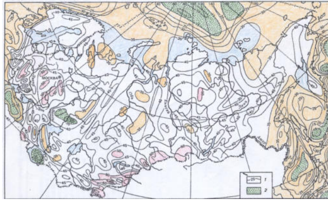
Рисунок 2. Схема глубинного строения земной коры в пределах территории России, близлежащих стран и ложа прилегающих морей. 1 — изогипсы глубин поверхности «М», км; 2 — области с отсутствием сейсмического «гранитного слоя».
