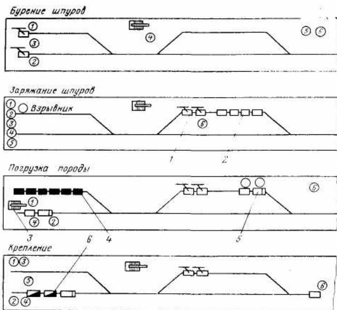
Схема размещения оборудования и рабочих (в кружочках) по процессам цикла при проведении выработок с применением двух бурильных установок БУЭ-1 и погрузочной машины 2ПНБ-2
