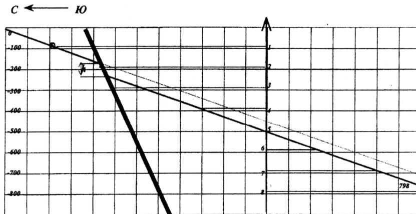
Рис.5. Шахтное поле со сбросом
