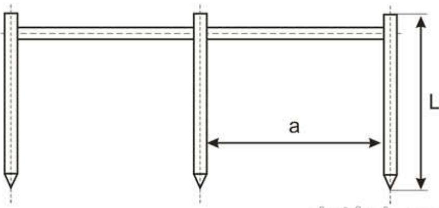
В зависимости от позволяющей площади и удобства монтажа заземляющие стержни можно размещать в ряд, либо в виде какой ни будь фигуры (треугольник, квадрат и т.п.).
