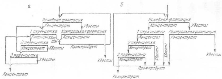
Рис.6. Схемы флотации с тремя перечистками концентрата и одной контрольной флотацией:
