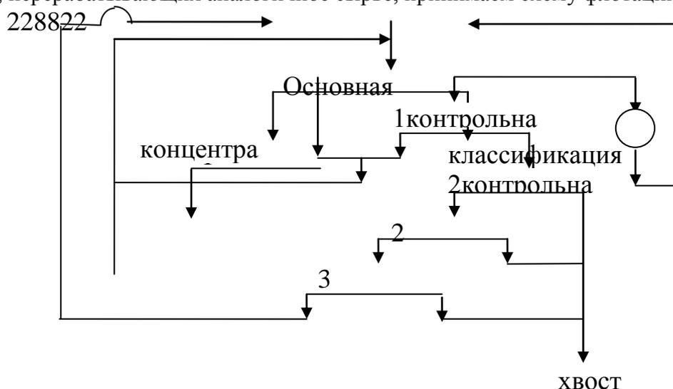
Рис.8. Схема медной флотации
