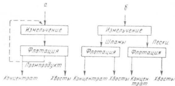
Рис. 1. Варианты принципиальных одностадиальных схем флотации
