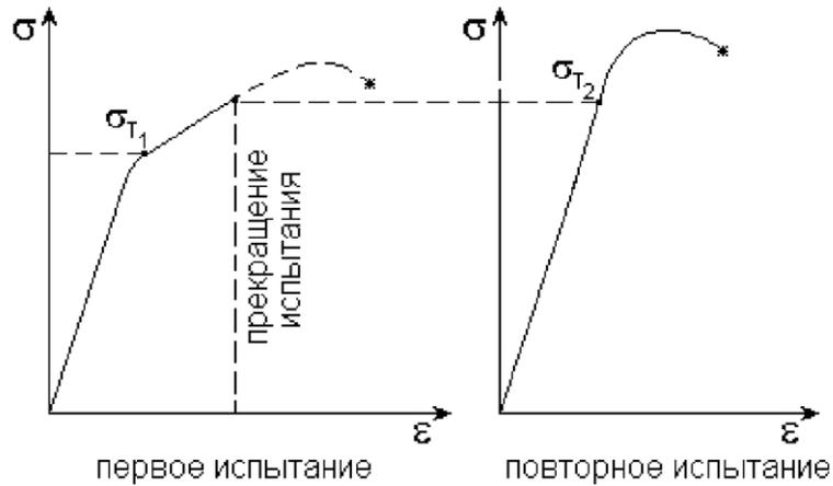
Рис. 3.2. Упрочнение металла при повторном испытании на растяжение
