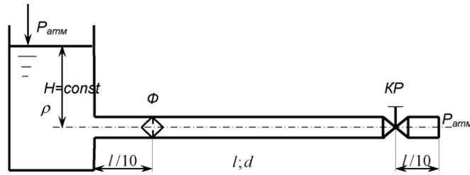
Рисунок 1.1 – Схема системы, состоящей из гидробака и трубы постоянного сечения.
