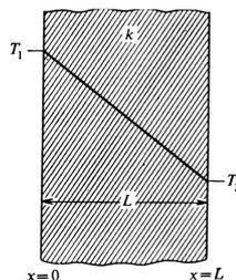
Рис. Теплопроводность через плоскую стенку с постоянным коэффициентом теплопроводности
