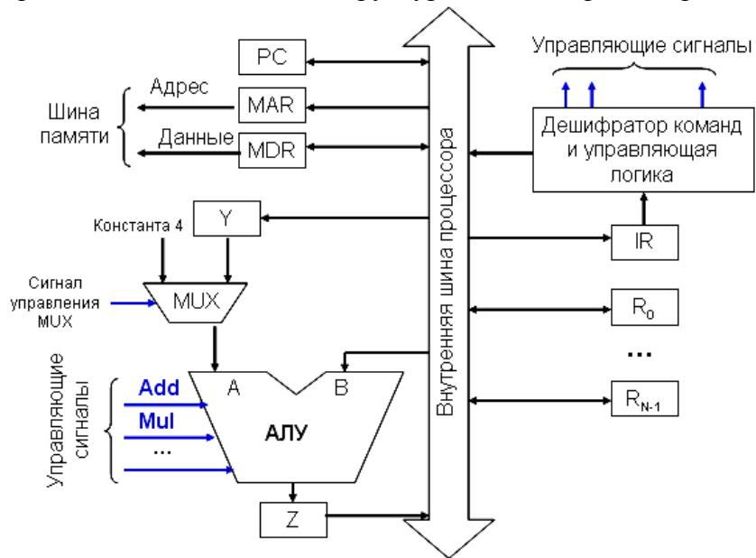
Управляющие сигналы, активирующие входной и выходной вентили некоторого регистра X, обозначаются X<sub>in</sub> и X<sub>out</sub>, соответственно. Какая последовательность управляющих сигналов должна быть выдана для пересылки содержимого регистра R1 в регистр R2?
