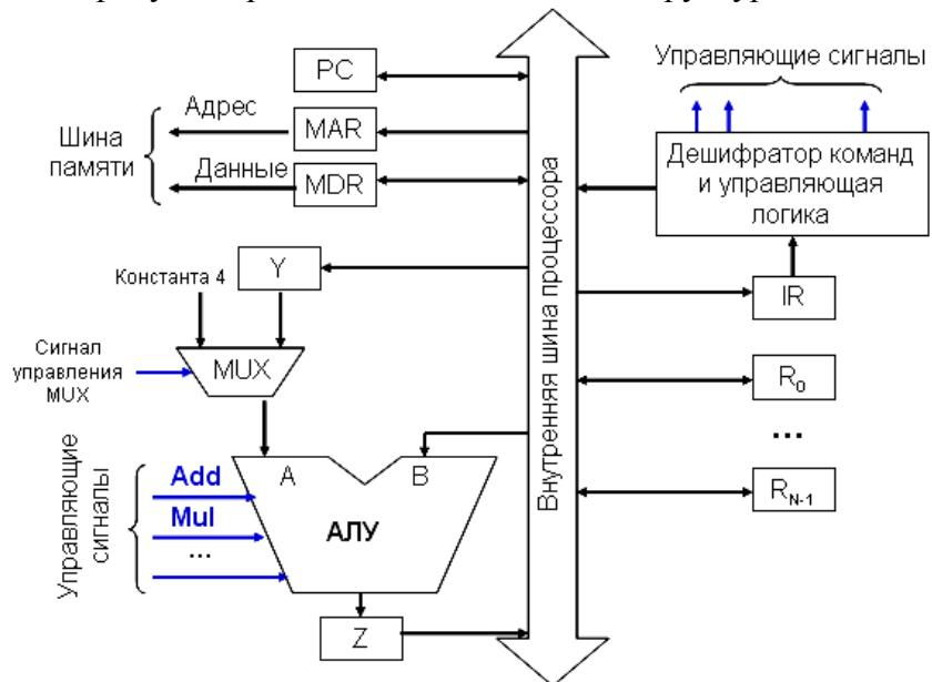
Управляющие сигналы, активирующие входной и выходной вентили некоторого регистра X, обозначаются X<sub>in</sub> и X<sub>out</sub>, соответственно. Какая последовательность управ员ющих сигналов должна быть выдана для пересылки содержимого регистра R1 в регистр R2?
