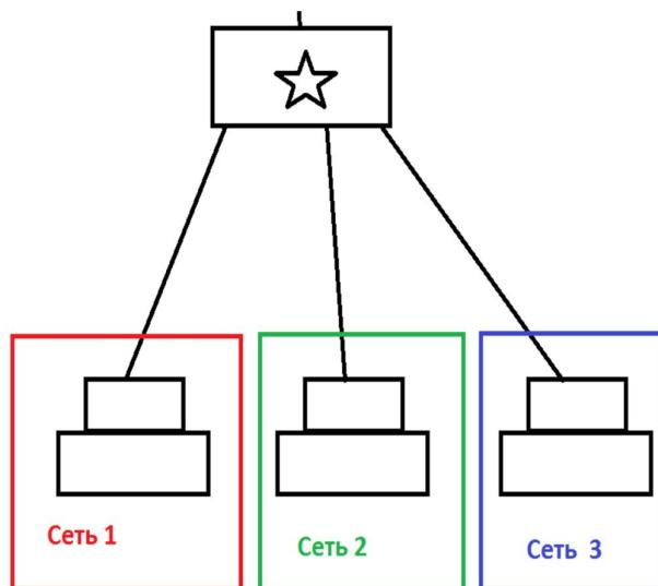
Рис. 1. Сегмент без маршрутизатора (звездой обозначен коммутатор).
