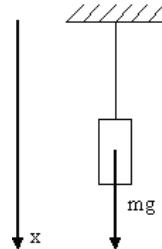
**Решение:** Напряжение вычисляется  $\sigma = F/S$ , где  $F$  – сила, действующая на единицу площади  $S$ . Упругая сила по модулю равна силе тяжести  $F = mg$ . Площадь  $S$  сечения проволоки  $S = \pi d^2/4$  (Площадь круга  $S = \pi r^2$ ), следовательно
