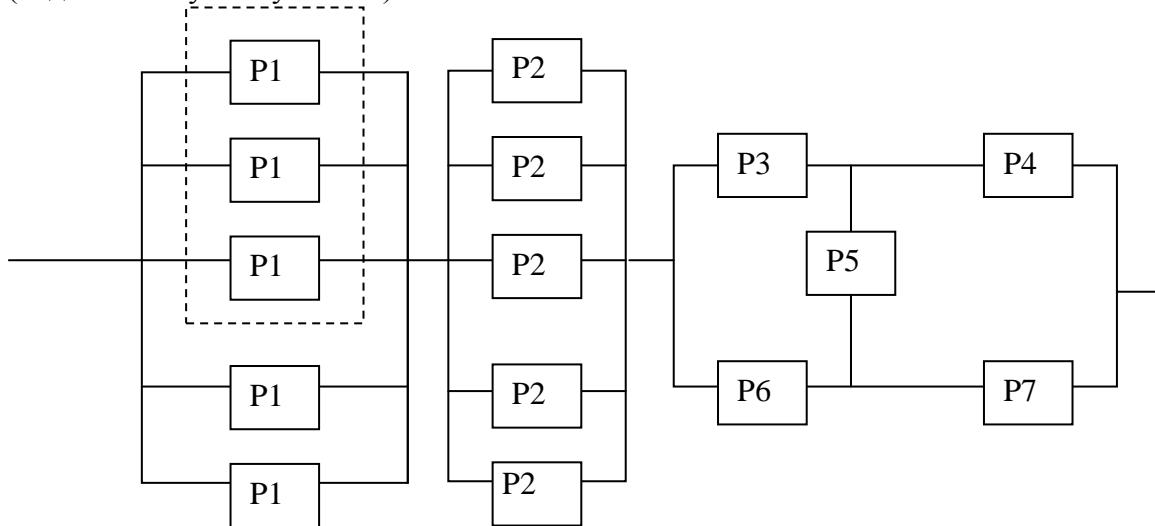
3. Рассчитать надежность технической системы, состоящей из совокупности узлов (надежности узлов указаны):
