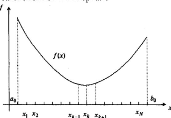
Далее продолжаем проводить поиск экстремума уже на интервале  $[x_{k-1}; x_k]$  и с меньшим шагом, до тех пор, пока не достигнем требуемой точности.
