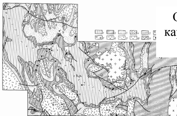
Рисунок 1.1 Положение Жаильминской грабен-синклинали в структуре Атасуйского района. Морские отложения: визейского (1), турнейского (2) и фаменского (3) ярусов; 4- эффузивы среднего и верхнего девона; 5-терригенные и туфогенные отложения силура, ордовика и верхнего кембрия; 6- лейкократовые граниты пермского возраста; 7-8-граниты и гранодиориты девонского возраста; 9-10-девонские эффузивы и интрузивные образования основного и среднего состава; 11-тектонические и разрывные нарушения; 12-железо-марганцевые и барит-полиметаллические месторождения района.
