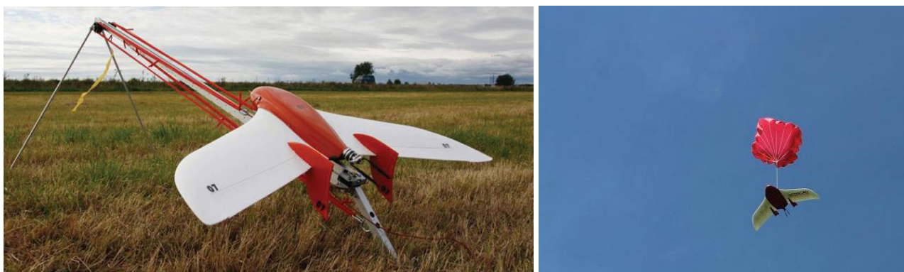
Рисунок 5. Подготовка к взлету и посадка БПЛА GeoScan 101
