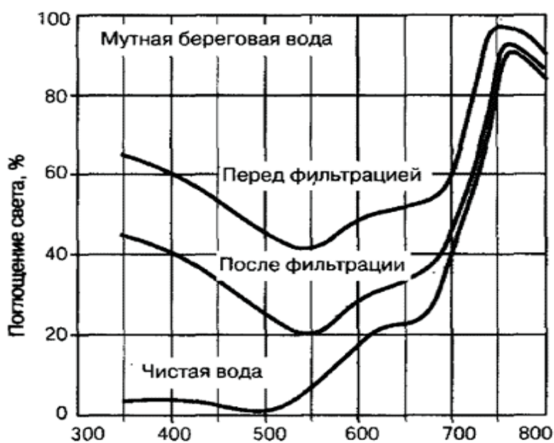
Рисунок 4. Зависимость процентной доли поглощенного водой света от длины волны света
