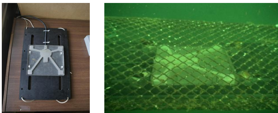
Рисунок 1. Погружной модуль установки биосенсорного онлайн биомониторинга (биосенсорный блок на платформе) в сборе перед использованием (слева) и после погружения в защитной сетке (справа): моллюски-мидии (4 экз) размещены по углам биосенсорного блока
