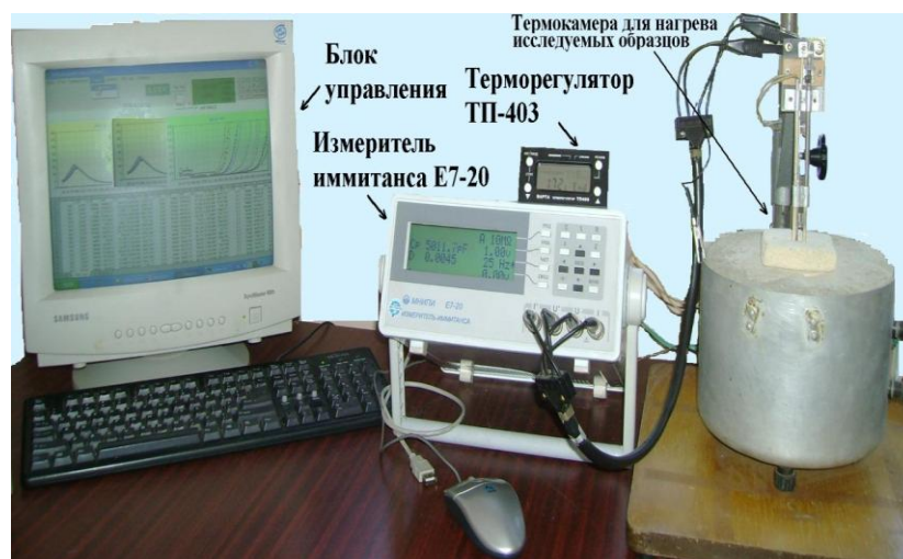
Рисунок 3. Автоматический измерительный стенд электрофизических параметров сегнето-пьезоматериалов, позволяющий проводить измерения в диапазоне частот от 25 Гц до 10^6 Гц
