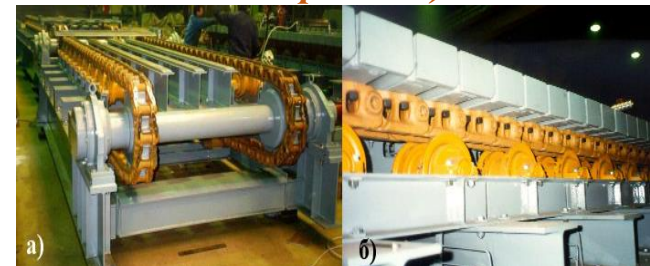
Двухвалковая дробилка первичного дробления DRC («ThyssenKrupp», Германия)
