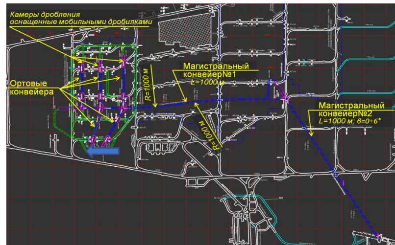
Схема модернизации откаточного гор. +170м в границах бл. 7/10 гор. +170 м с использованием конвейерного транспорта
