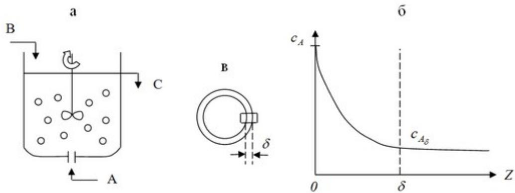
Рис. реактор с мешалкой и подачей газа в форме пузырьков (а), график функции  $C_A=f(z)$  (б), отдельный пузырек, окруженный слоем жидкости толщиной  $\delta$  (в)
