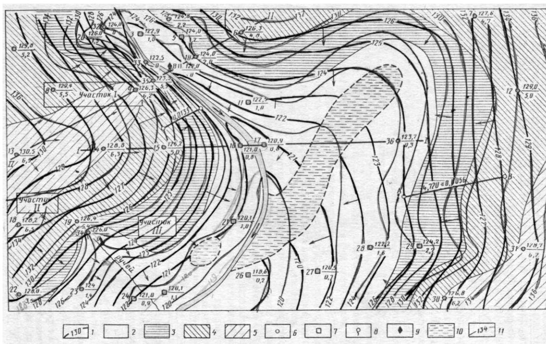
Рис. 3. Карта гидроизогипс и глубин залегания грунтовых вод:
