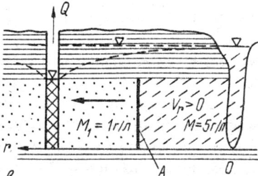
Рис. 1. Схема гидрогоехимической миграции в подземных водах при конвективном переносе или поршневом вытеснении (сверху вниз):
