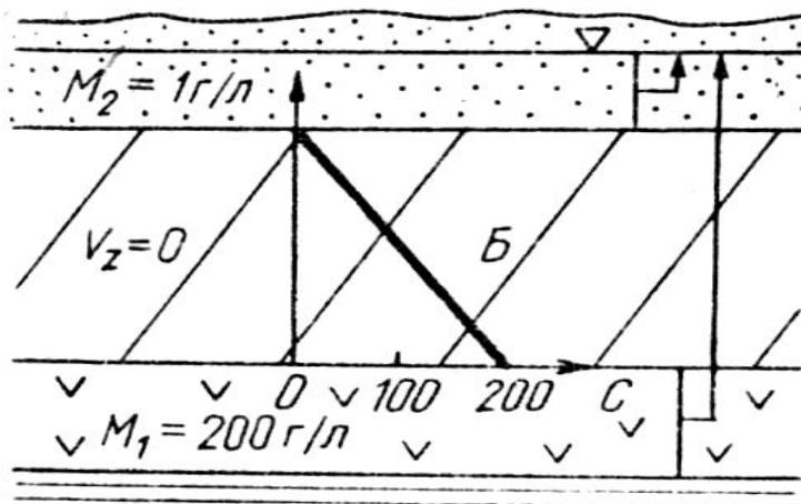
Рис. 2. Схема гидрогохимической миграции в подземных водах при диффузионном переносе (сверху вниз): 1 – водоносные пески; 2 – относительно проницаемые породы (суглинки); 3 – водоносные гипсы; 4 – водоупорные глины.
