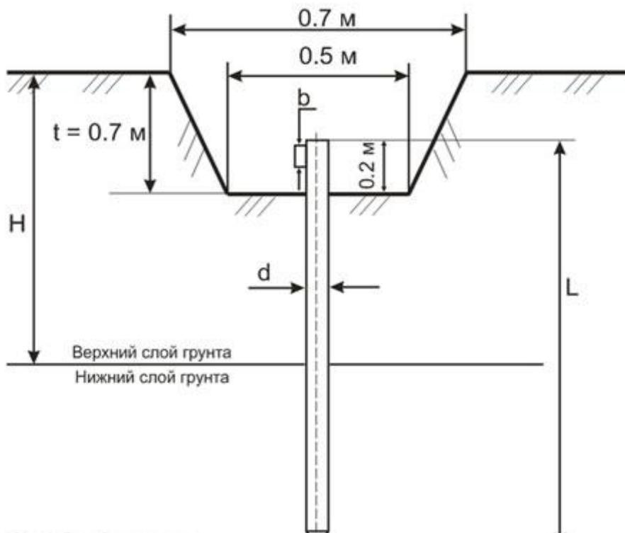
1.3. Расстояния между заземляющими стержнями берется из соотношения их длины, то есть:  $a = 1 \times L$ ;  $a = 2 \times L$ ;  $a = 3 \times L$ .
