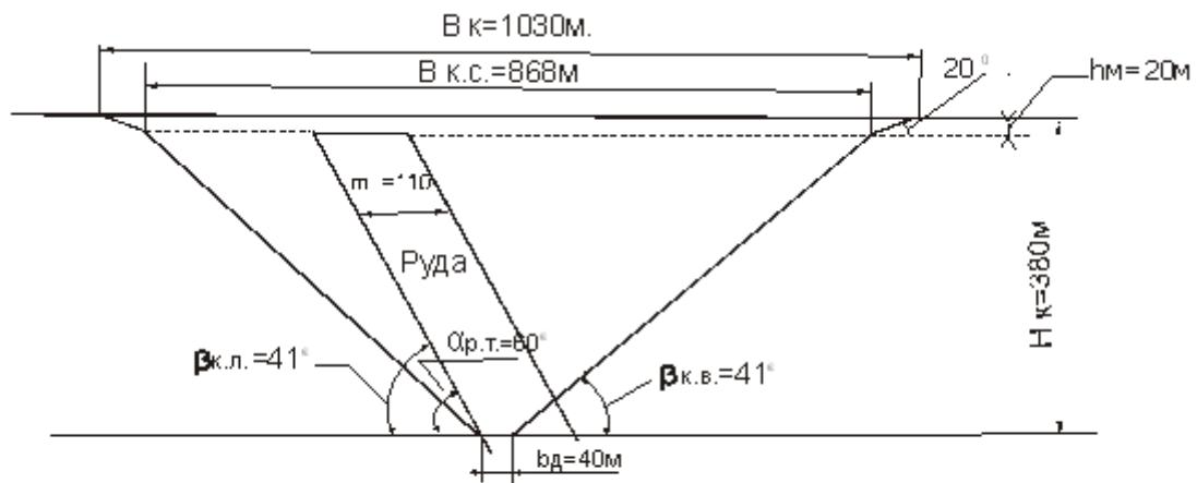
Рис. 1. Контуры карьера на поперечном разрезе,
