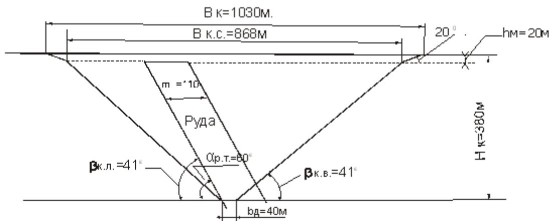
Рис. 1. Контур карьера на поперечном разрезе,
