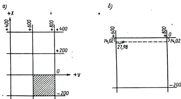
Рисунок 5. Построение координат точек планового съемочного обоснования.
