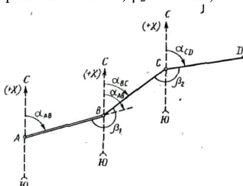
Рис. 1. К вычислению дирекционных углов сторон теодолитного хода.
