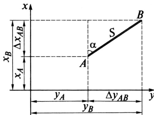
Рис. 1. Решение прямой и обратной геодезических задач.
