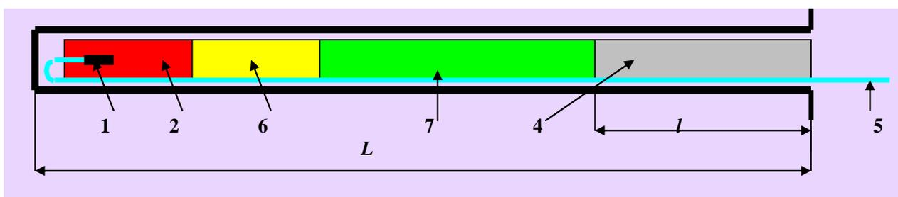
1 – капсюль; 2 и 6 – патрон аммонит №6 ЖВ; 7 – Гранулит - М; 4 – забойка; 5 – волновод НСИ;  $L$  – глубина шпура;  $l$  – величина незаряженной части шпура.
