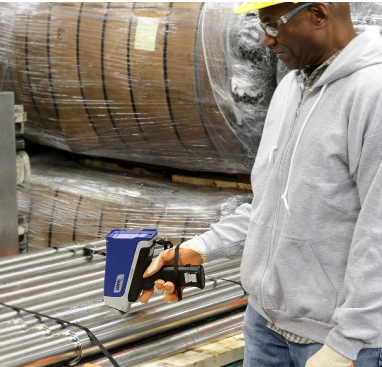
Поскольку цена на переработанные вторичные металлы постоянно колеблется, быстрая идентификация марок сплавов очень важна для обеспечения рентабельности и получения прибыли. Портативные рентгенофлуоресцентные анализаторы Vanta™ для сортировки лома позволяют за секунды определить марку сплава или металла.
