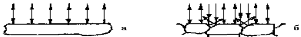
Рис. 3. Схема отражения световых лучей от поверхности полированного (а) и подвергнутого травлению (б) микрошлифа.
