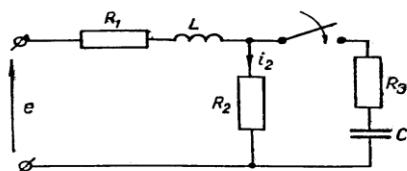
**6-2** В цепи постоянного тока, представленной на схеме, определить переходное напряжение на емкости  $u_c$ .
