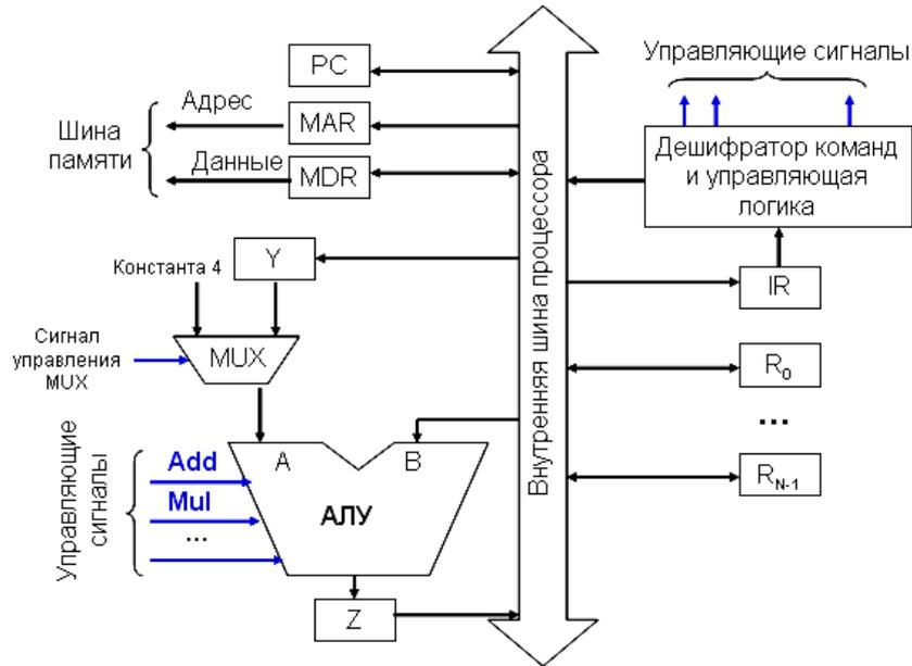
Управляющие сигналы, активирующие входной и выходной вентили некоторого регистра X, обозначаются  $X_{in}$  и  $X_{out}$ , соответственно. Какая последовательность управляющих сигналов должна быть выдана для пересылки содержимого регистра R1 в регистр R2?
