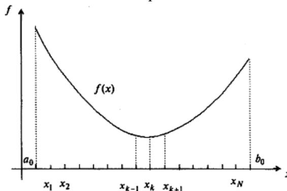
Далее продолжаем проводить поиск экстремума уже на интервале  $[x_{k-1}; x_k]$  и с меньшим шагом, до тех пор, пока не достигнем требуемой точности.
