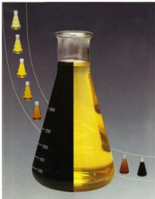
Рисунок 2. Окисляемость трансформаторного масла вследствие ионов меди
