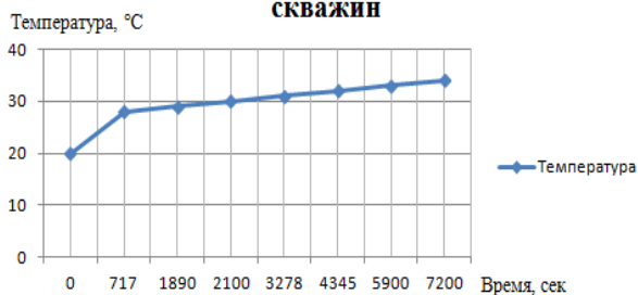
График изменения температуры на стенках соляного барьера соседних скважин
