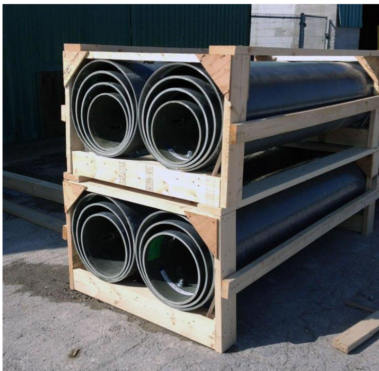
Рисунок 1. Принцип хранения и перевозки композитных опор
