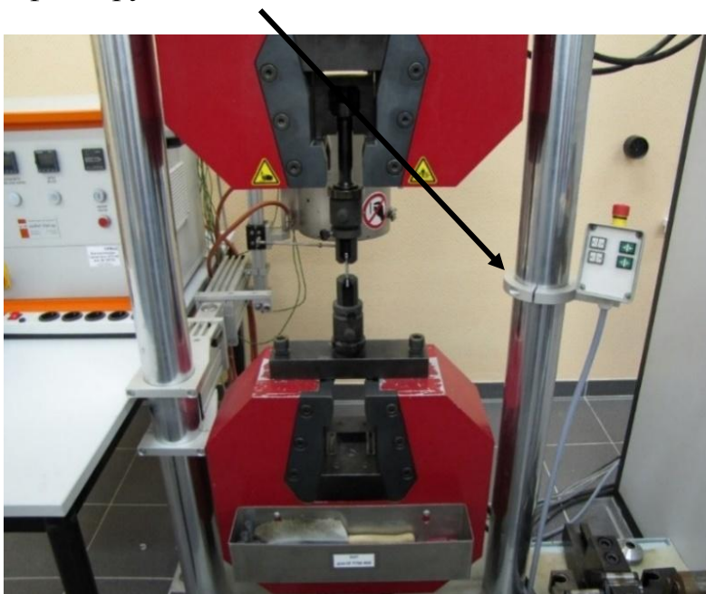
Рисунок 1. Фиксация образца на машине LF– TT400
