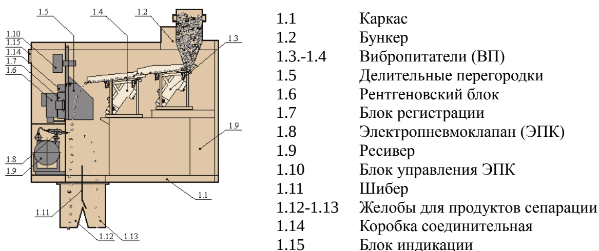
Рисунок 1. Общий вид рентгенолюминесцентного сепаратора на примере сепаратора ООО «ЭГОНТ» [3]
