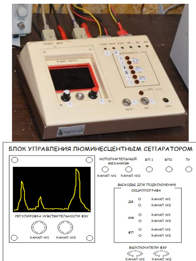
Рисунок 13. Схема блока управления и первичной обработки сигнала люминесцентного сепаратора (ВП – вибропитатель, ТУ – транспортирующее устройство, ДЯ – датчик наличия ячейки, ИМ – исполнительный механизм, ФП – фотоприемник)
