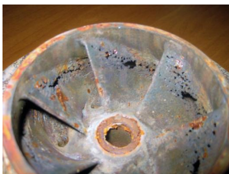
Рис. 1. Воздействие кавитации на турбинные лопатки.
