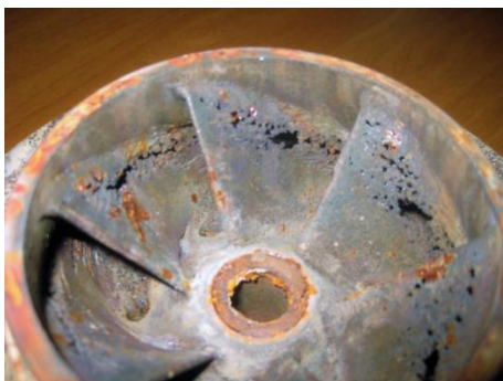
Рис. 1. Воздействие кавитации на турбинные лопатки.
