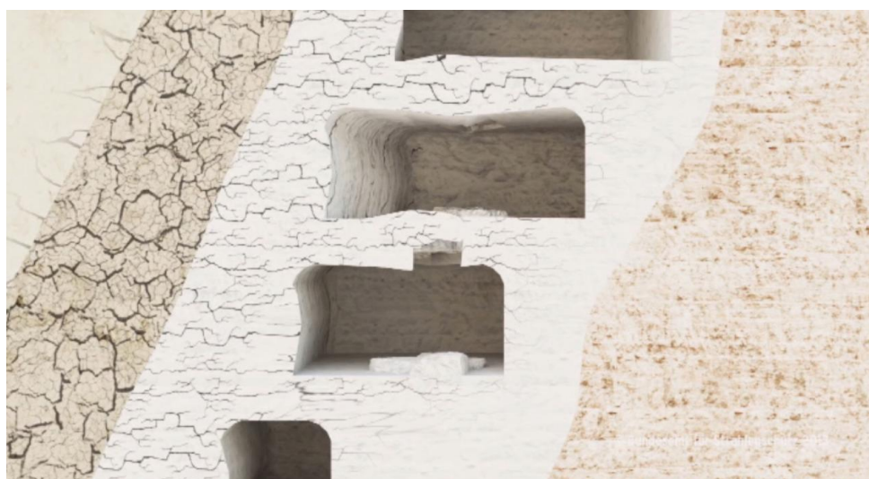
Рисунок 2. Трещины стенок шахты Asse-II
